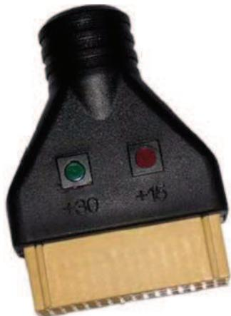
Figura 957 - Connettore di autodiagnosi
